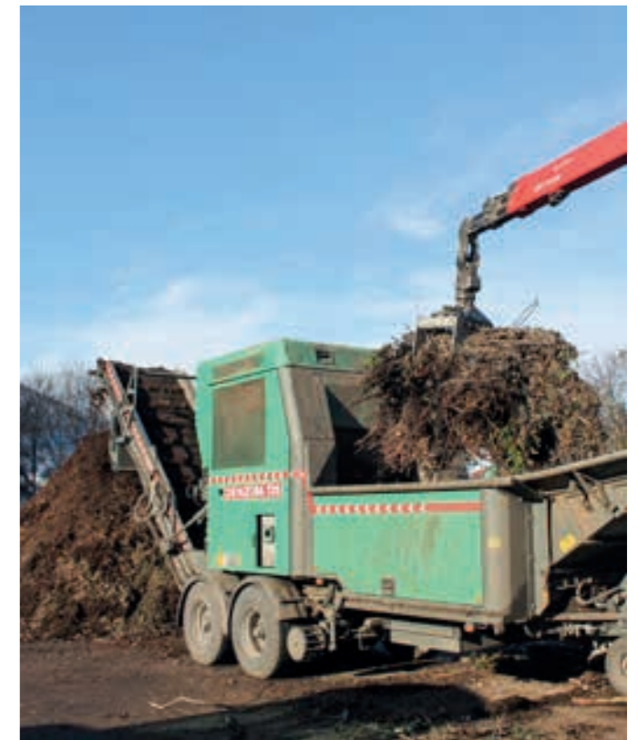
Kompostieranlage der Stadt Lienz - Gehölzschnitt wird vor der Kompostierung zerkleinert
